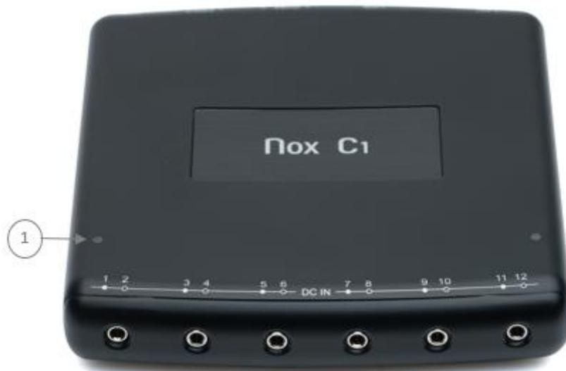
Der Lichtsensor kann für die Lichterkennung im Patientenzimmer genutzt werden. Damit der Lichtsensor ordnungsgemäß funktioniert, müssen Sie darauf achten, den Nox C1-Lichtsensor nicht zu verdecken. Die technischen Daten für den Lichtsensor finden Sie im Abschnitt „Technische Daten“.
