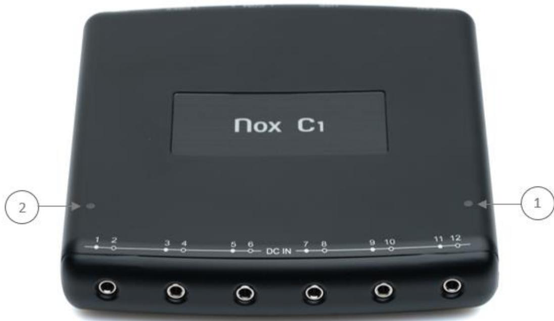
Die Abbildung unten zeigt die Vorderansicht des Nox C1 mit den sechs analogen Eingängen , bezeichnet mit DC IN 1-12.
