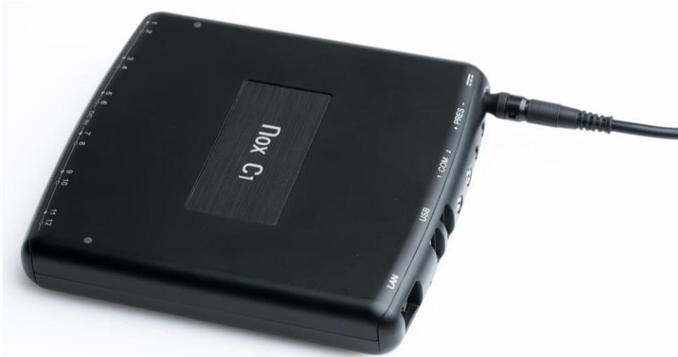
Überprüfen Sie, ob die LED-Anzeigeleuchte oben auf dem Nox C1-Gerät sofort nach dem Anschließen des Netzteils gelb und anschließend grün blinkt, wenn der Startvorgang des Geräts abgeschlossen und das Nox C1 für die Konfiguration verfügbar ist.
