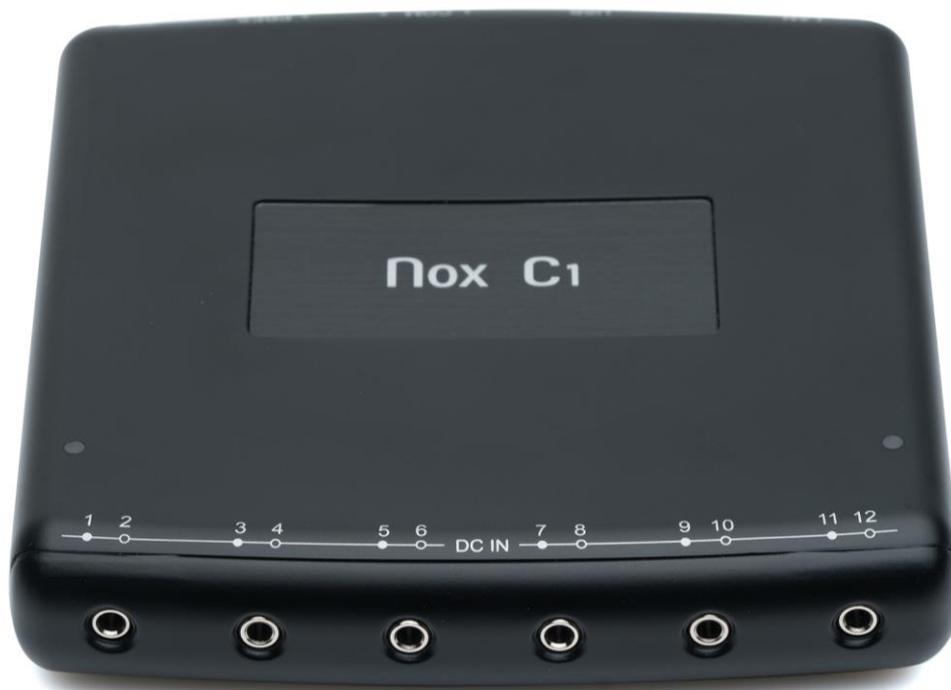
Die Abbildung unten zeigt die Rückseite des Nox C1 mit den sechs verfügbaren Eingängen. Siehe die folgende Tabelle für die Definition der Anschlüsse.
