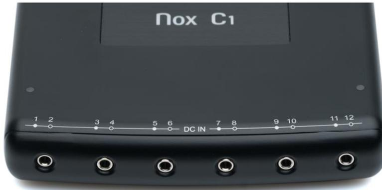
Die 12 analogen Kanäle des Nox C1 besitzen sechs Eingänge, die mit DC IN von 1 bis 12 bezeichnet sind, siehe Abbildung oben. Die folgenden Tabellen enthalten die Kanalbezeichnungen.
