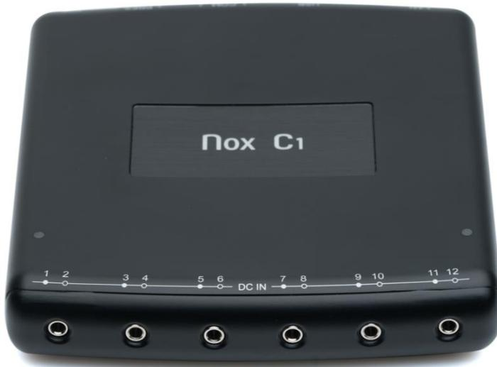
La figura sottostante mostra la parte posteriore del Nox C1, che mostra i sei input disponibili. Fare riferimento alla tabella sottostante per la definizione dell'input.
