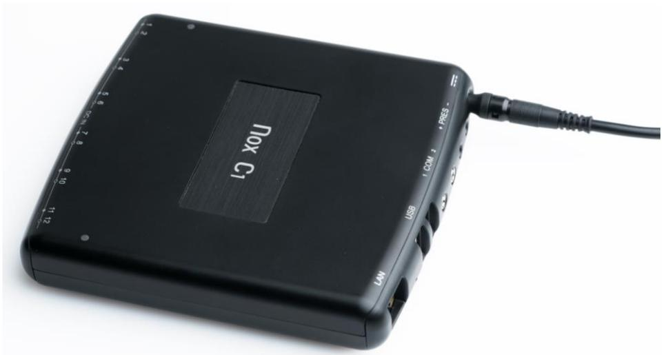
Verificare che l'indicatore LED nella parte superiore del dispositivo Nox C1 inizi a lampeggiare con una luce color ambra immediatamente dopo il collegamento dell'alimentazione e che inizi a lampeggiare con una luce verde quando la sequenza di avvio del dispositivo è completata ed il Nox C1 è pronto per la configurazione.
