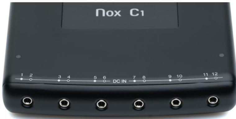
I 12 canali analogici offerti dal Nox C1 hanno sei input etichettati DC da 1 a 12 (vedere figura sopra). La tabella sottostante riguarda l'identificazione del canale.
