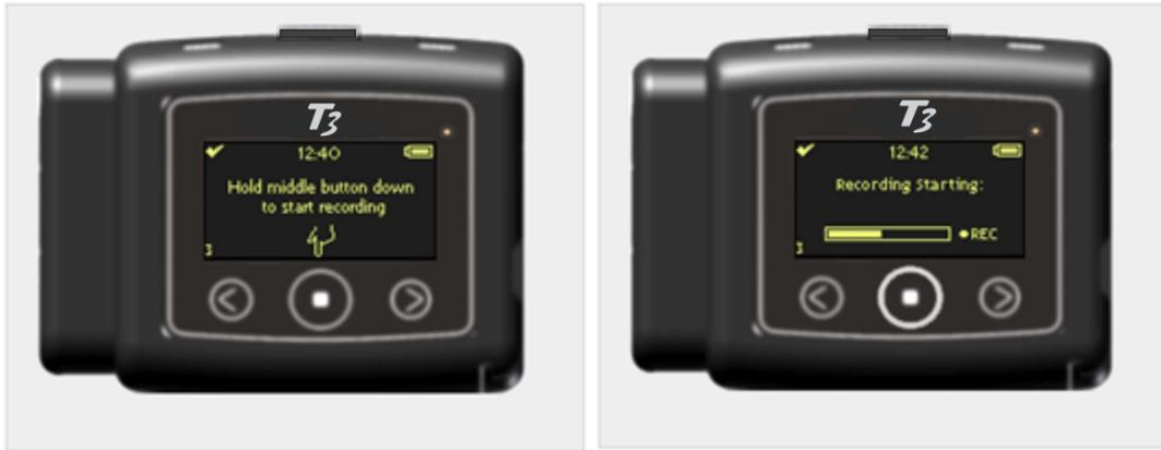
Se durante la configurazione del dispositivo è stata specificata la durata della registrazione, la registrazione sarà interrotta automaticamente dopo il termine indicato.
