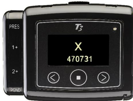
Questo significa che l'associazione tra il registratore Nox T3 e l'ossimetro non è stata completata e la programmazione dell'ossimetro non è riuscita. Sarà necessario ripetere la procedura di associazione. Per prima cosa, tuttavia, occorre riavviare l'ossimetro. Per farlo, togliere e rimettere le batterie dell'ossimetro. Tenere premuto quindi il pulsante di attivazione grigio sull'ossimetro per almeno tre secondi. Riprendere la procedura di associazione dalla fase 3 illustrata sopra.
