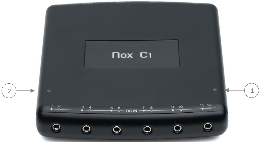
L'image ci-dessous montre l'avant du point d'accès Nox C1, avec les six entrées analogiques dénommées DC IN 1-12.
