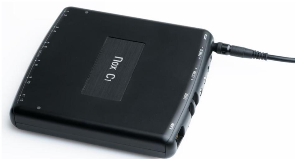
Vérifiez que le DEL sur le haut du point d'accès Nox C1 commence à clignoter en orange immédiatement après la connexion de l'alimentation et clignote en vert lorsque la séquence de démarrage de l'appareil est terminée et le point d'accès Nox C1 est prêt à être configuré.
