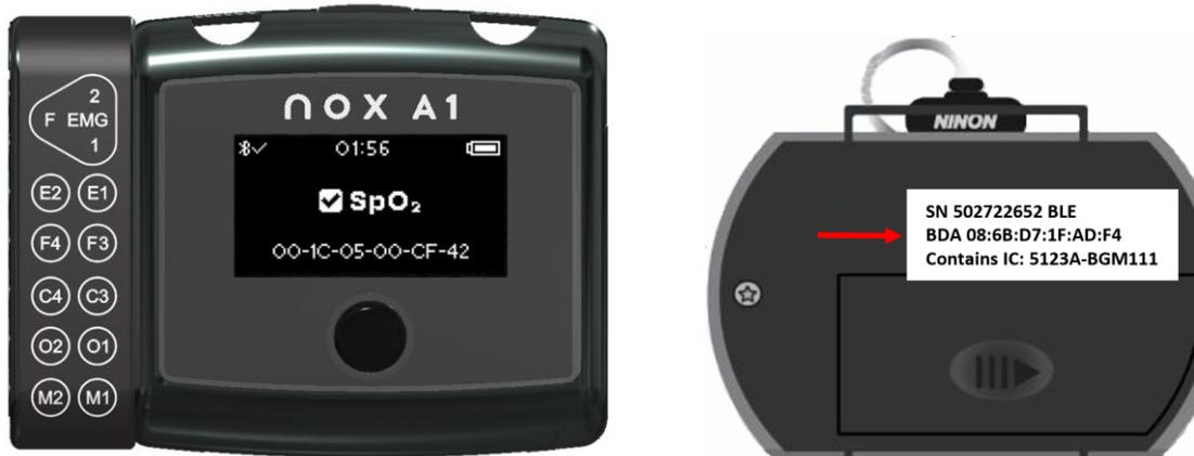
Falls die Nummer auf dem Gerät nicht mit der Nummer des Oximeters übereinstimmt, müssen Sie den Nox A1s in Noxturnal neu konfigurieren und dort die richtige BDA-Nummer eingeben (wie in Schritt 3 der Kopplung):
